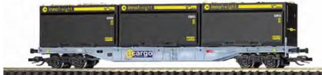
31142 Containertragwagen Sgns 691 mit 3 Holzschnitzeleinheiten
